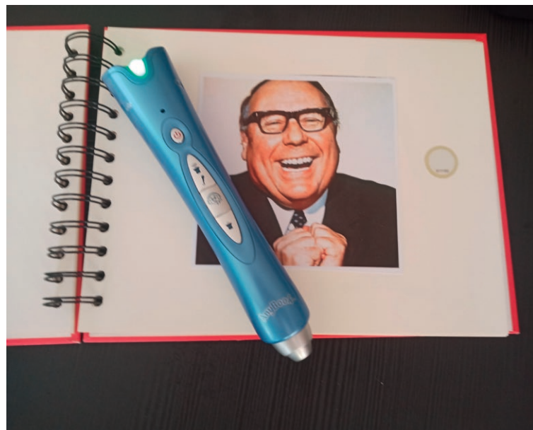
Abb. 3: Beispiele fr einfache elektronische HM: BigMack und AnybookReader (Fotos: eigene Aufnahmen)
